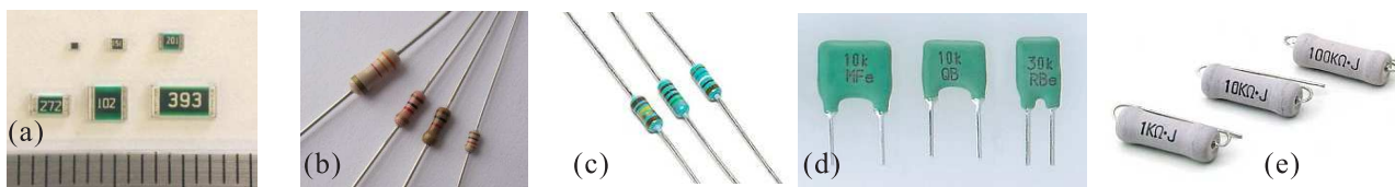
図 1.7 様々な小電力固定抵抗器。(a) 表面実装用。(b) 炭素被膜抵抗。1/2W 型から 1/8W 型まで。円筒形で抵抗値はカラーコード表示（後述）されている。(c) 金属皮膜抵抗。円筒型、カラーコード表示。1/4W 型。(d) 角型金属皮膜抵抗。(e) 1/2W 型円筒形参加金属皮膜抵抗。
