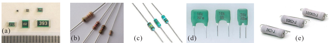
図 1.9 様々な小電力固定抵抗器。(a) 表面実装用。(b) 炭素被膜抵抗。1/2W 型から 1/8W 型まで。円筒形で抵抗値はカラーコード表示 (後述) されている。(c) 金属皮膜抵抗。円筒型、カラーコード表示。1/4W 型。(d) 角型金属皮膜抵抗。(e) 1/2W 型円筒形参加金属皮膜抵抗。
