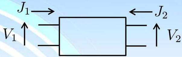
$$\begin{pmatrix} V_1 \\ J_1 \end{pmatrix} = \begin{pmatrix} A & B \\ C & D \end{pmatrix} \begin{pmatrix} V_2 \\ J_2 \end{pmatrix}$$
